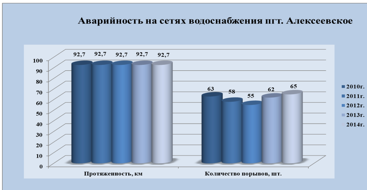
Рис.8 Аварийность на сетях водоснабжения пгт. Алексеевское
