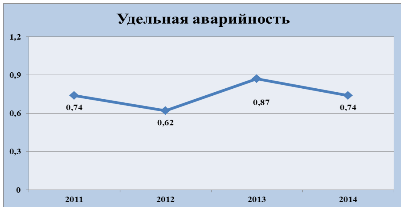
Рис. 21 Удельная аварийность на самотечных сетях водоотведения пгт. Алексеевское
